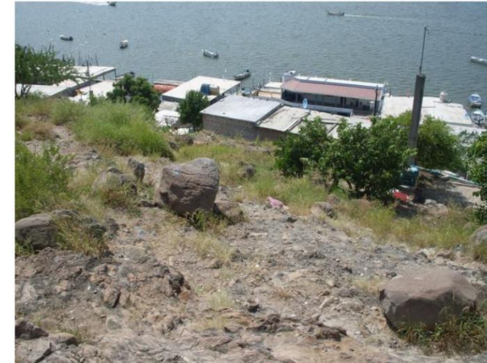
**Figura 5.1.6.8. Bloques sueltos, independizados del macizo rocoso, con el potencial de volcar y rodar pendiente abajo, afectando a las viviendas.**
