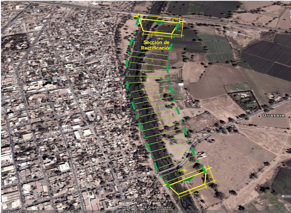
IMAGEN AÉREA DONDE SE MUESTRA LA EXTENSIÓN DE LAS OBRAS DE DRAGADO SOBRE LA MARGEN IZQUIERDA DEL RÍO SINALOA, HACIA DONDE SE TIENE PREVISTO EL PLAN PARCIAL DE DESARROLLO URBANO.
